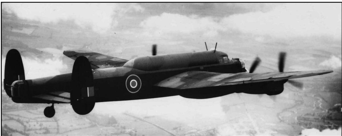
Le Lancaster HK541 photographié lors d'un test en vol en Grande-Bretagne et équipé d'un '*Saddle tank*' de 1200 Imp Gal (5455 l) sur le dos. Ce réservoir était utilisable indifféremment sur le Lancaster ou le Lincoln et leur permettait d'avoir un rayon d'action de plus de 2400 km avec une charge de bombes de 2.7 tonnes.
